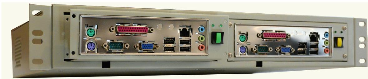
Данная платформа предназначена для построения АТС емкостью до 2000 абонентов и до 8 трактов Е1. Обеспечивается до 100 одновременных вызовов.
