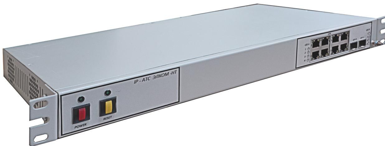
Вычислительная мощность платформы обеспечивает поддержку до 1000 абонентов и 60 одновременных вызовов.
