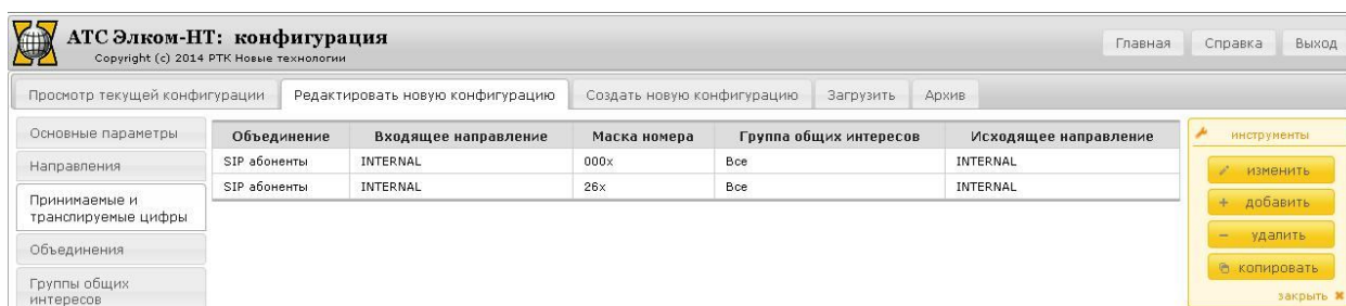
Рис.5.6. Конфигурирование таблицы принимаемых и транслируемых цифр (ПИТЦ)
